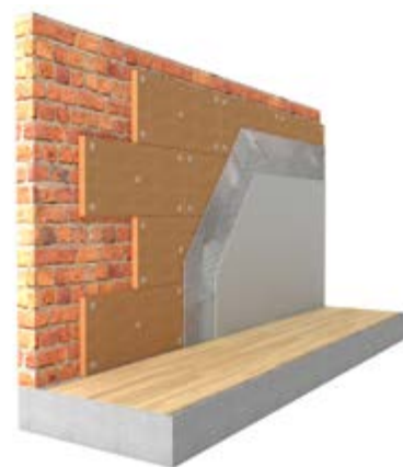
Figura 2 Esempio di una soluzione per cappotto termico interno naturale realizzato in fibra di legno Fibertherm® protect
