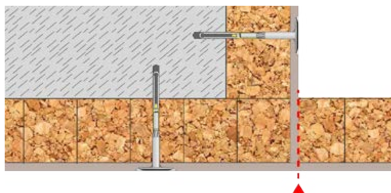
Figura 16 Realizzazione di angoli nel sistema Betontherm
